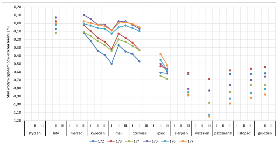
Ryc. 10. Stany wód gruntowych w piezometrach w ciągu pomiarowym Trójkąt II (Basen Środkowy).
