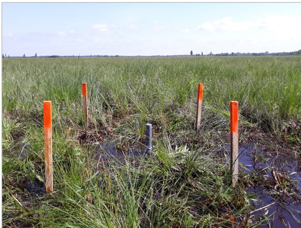
Ryc. 22. Zainstalowany piezometr nr 266, maj 2019, fot. J. Zawadzka.
