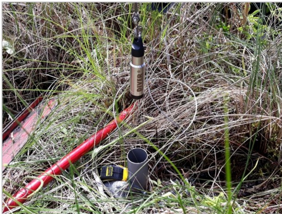
Ryc. 24. Automatyczny czujnik stanów wód podziemnych - piezometr nr 267, maj 2019, fot. J. Zawadzka
