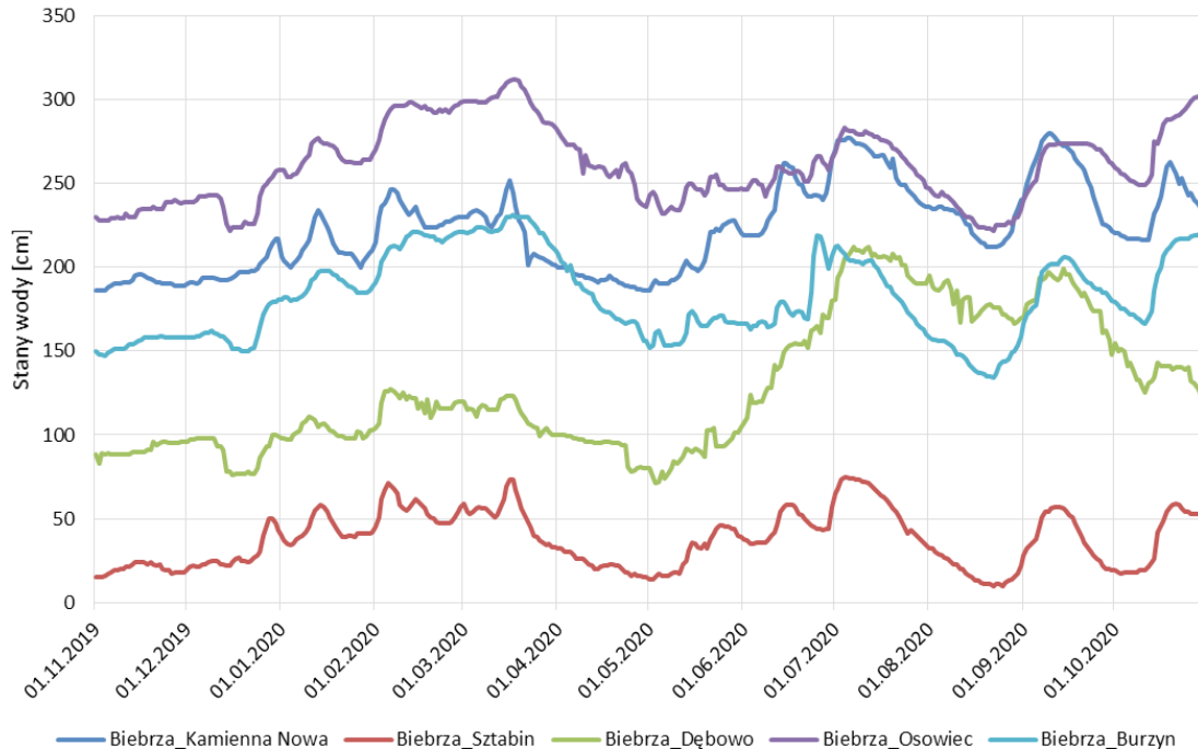
RYC.4. STANY WÓD RZEKI BIEBRZY W PROFILU KAMIENNA NOWA, SZTABIN, DĘBOWO, OSOWIEC I BURZYN W ROKU HYDROLOGICZNYM 2020 (NA PODSTAWIE DANYCH: BBPN ORAZ HTTPS://HYDRO.IMGW.PL/ ).
